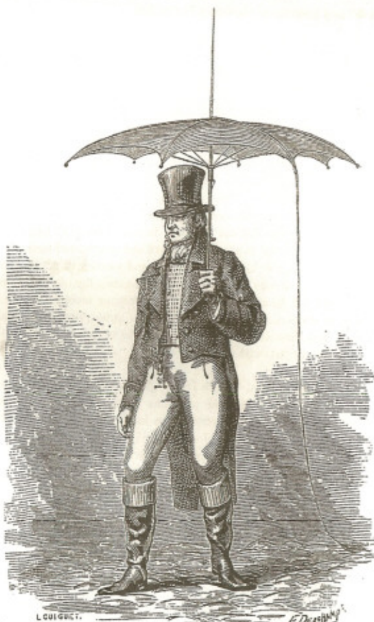
Fig. 314. — Le paratonnerre portatif, ou le parapluie-paratonnerre de Barbeu-Dubourg.
